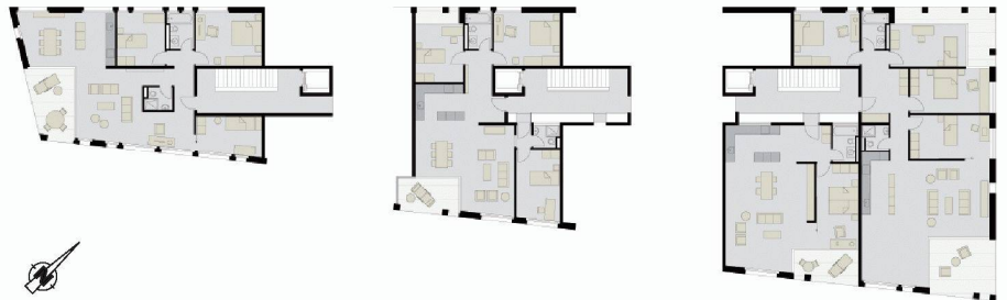
Wohnungstypen für Familien – eine adäquate Grösse der Nasszellen und ausreichende Belichtung der Küchen müssen noch erreicht werden (Siegerprojekt)
