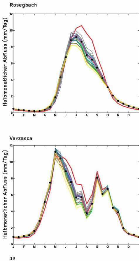
02 Halbmonatlicher Abfluss des Rosegaches im Oberengadin (oben) und der Verzasca im Tessin für die Periode 2020 – 2049 in mm pro Tag. Rot gestrichelt ist der Wasserabfluss für die Kontrollperiode 1961 – 1990, die Punkte zeigen den Medianwert des Abflusses von neunzehn verschiedenen, mit farbigen Linien aufgezeichneten Klimaszenarien (Bild: Lit. 4)
