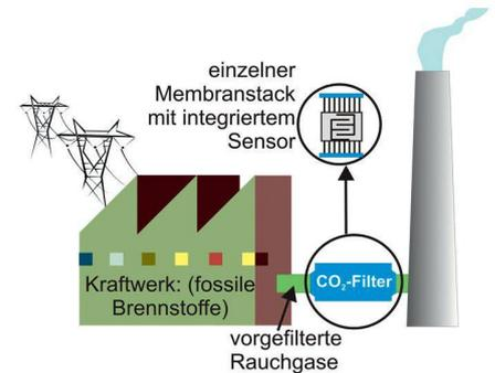
Mehr als ein Drittel der Kohlendioxidemissionen in Europa stammen aus Kraftwerken, die fossile Brennstoffe verfeuern. Eine Möglichkeit, diese Emissionen deutlich zu verringern, ist die Speicherung des Treibhausgases in unterirdischen Hohlräumen. Um Kohlendioxid unterirdisch zu speichern, muss es zuerst abgetrennt und aufgefangen werden. Die Trennung des CO<sub>2</sub>-Gases von den anderen Bestandteilen des Rauchgases ist derzeit noch schwierig und anspruchsvoll.
