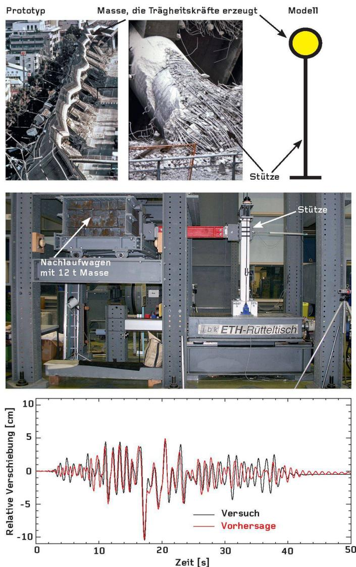
03 Nichtlineare Kraft-Verformungs-Beziehung von U-förmigen Stahlbetontragwänden: Vergleich zwischen Versuchen und numerischen Simulationen anhand eines äquivalenten Rahmenmodells gemäss Anm. 6:
