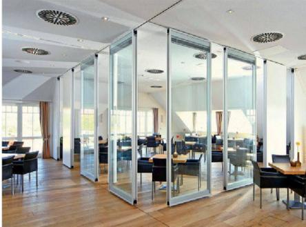
Mit dem Raumtrennsystem «MOVEO Glas» von Dorma lassen sich bewegliche, transparente Raumtrennsysteme mit bis zu  $R_w$  50 dB Schallschutz realisieren. Das System kombiniert Transparenz mit hohem Schallschutz, Bedienkomfort und grosser Variabilität. Dafür sorgen doppelschlag verglaste Wandsysteme, deren Rahmen nur 30mm an den Längsseiten und 118mm im Kopf- und Sockelbereich messen. Ein Element ist 100mm dick, die lichte Höhe kann zwischen 2000 und 4000mm variieren. Die einzelnen
