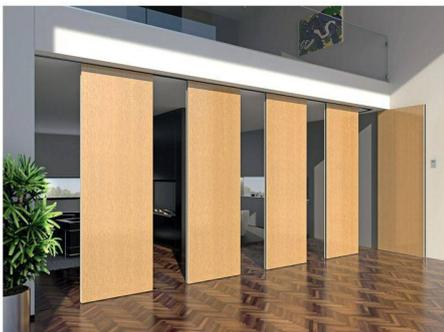
Die jüngste Neuentwicklung von Hawa ist «Hawa-Motus 150/H-matic», ein automatisiertes Schiebepeschlagsystem für grosse Trennwandanlagen aus Holz. Mit «Hawa-Motus 150/H-matic» können 20 bis zu 150 kg schwere, mobile Türelemente aus Holz zu einer 30m breiten Anlage verbunden wer-
