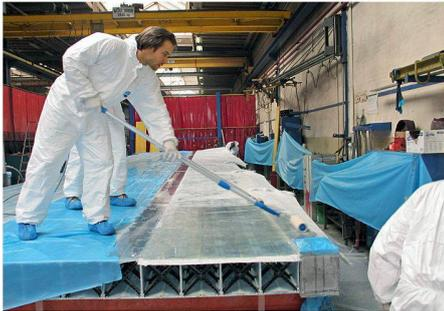
01+02 Umlaminierung der einzelnen Segmente und Aufbringen des Dünnschichtbelags
