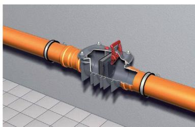
ACO Doppelrückstauverschluss **TRIPLEX-K-2** zum Einbau in eine freiliegende Rohrleitung. Er enthält zusätzlich einen Notverschluss, welcher in der hinteren Klappe integriert ist. Dieser dient als zusätzliche Sicherheit und kann von Hand betätigt werden.
