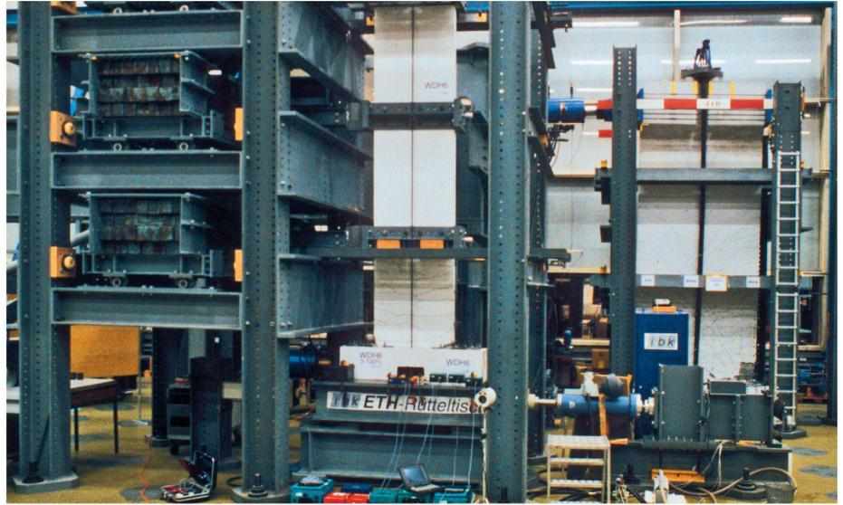
02 Erdbebensimulator am Institut für Baustatik und Konstruktion IBK der ETH Zürich
