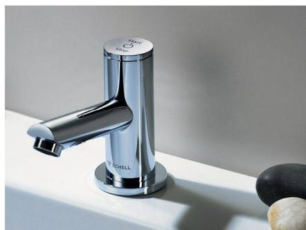
Die neue elektronische Selbstschluss-Armatur von Schell eröffnet ab sofort vielfältige Anwendungsmöglichkeiten für Waschtische. Gegenüber hydraulisch gesteuerten Selbstschluss-Systemen erfolgen der Öffnungs- und der Schliessimpuls bei «Tipus P» über ein batteriebetriebenes Magnetventil, das sich unter dem Waschtisch befindet.
