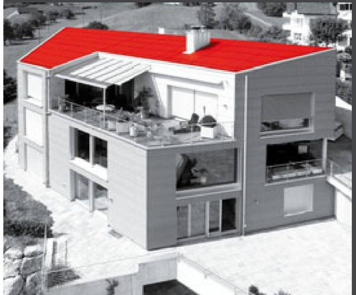
Mit nur 6° Minimalneigung ist das INTEGRAL PLAN Dachsystem kein Flachdach, aber das Flachste in seiner Kategorie. Die Plattenmodule von bis 2500 × 1220 mm sorgen für das eigenständige Design.
