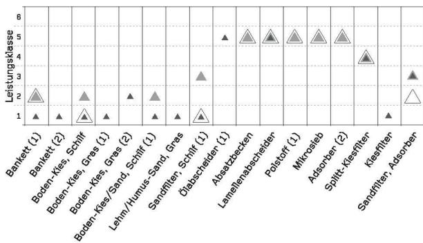
Vergleich der hydraulischen Leistungsfähigkeit
