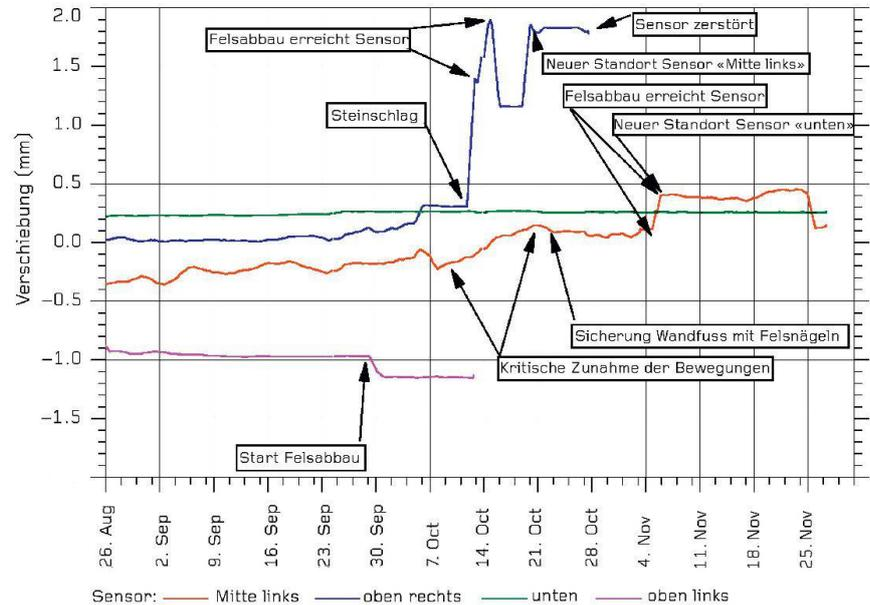
**04** Aufzeichnung der Verschiebungsmessungen der Felsbewegungen während der Ausführungsarbeiten mit Telejointmeter. Mit der provisorischen Vernagelung konnten die Bewegungen am Fuss des Felspfeilers (rote Linie) gestoppt werden
