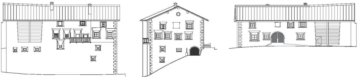
**08 Ansicht Süd, Ost und Nord.** Die starke Hanglage zum Inn hin führte zum Bau von zwei Untergeschossen, was den Sockelbereich aussergewöhnlich massiv wirken lässt. An den vergitterten Fenstern der Südfassade ist die Lage der Vorratskammer ablesbar. Das Tor an der Ostfassade führte zum im Untergeschoss gelegenen Stall, durch das Tor im EG (Nordfassade) wurde der Heustall erschlossen (Alle Pläne: Christoph Sauter Architekten)
