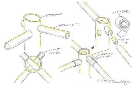
01–03 Das Raumteilersystem PPS4 ermöglicht ein Minimum an Privatsphäre in grossen Notunterkünften. Vier Module (2 x 2 m) bilden einen Raum mit 16 m<sup>2</sup>: Stütze Kartonrohr  $\varnothing=96$  mm, Balken Kartonrohr  $\varnothing=56$  mm, Verbindung (eingeschoben) Kartonrohr  $\varnothing=49.7$  mm, Vorhang aus wiederverwertetem Synthetikstoff (Foto: VAN, Skizze: Shigeru Ban)
