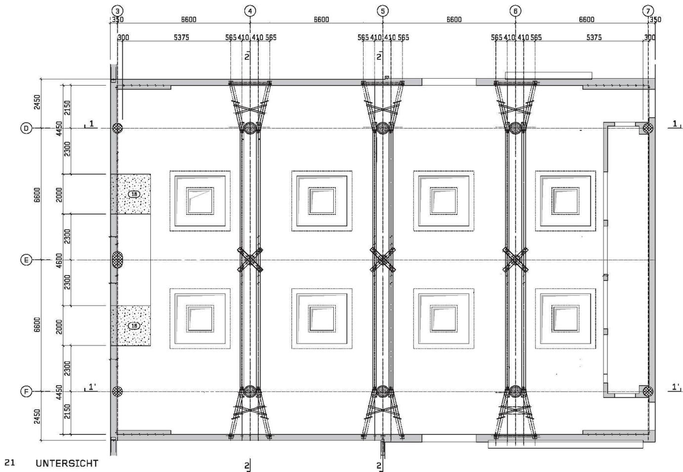
21 Dynamische Bauweise: Im grossen Hörsaal, wo die bestehende Statik aufgebrochen werden musste, wurde zuerst das neue Tragwerk erstellt, und erst dann wurden die tragenden Ele-
