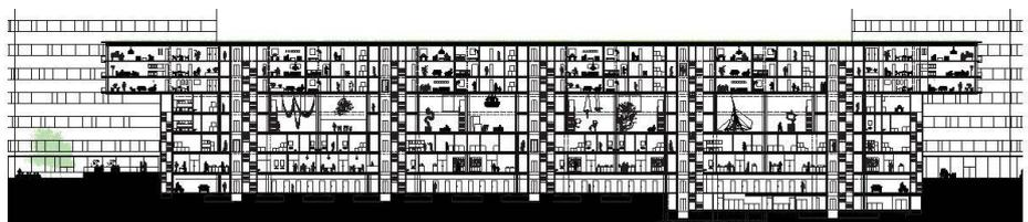
02 Längsschnitt, Mst. 1:1500: unten Betonstruktur aus den 1960er-Jahren, oben aktueller Leichtbau
