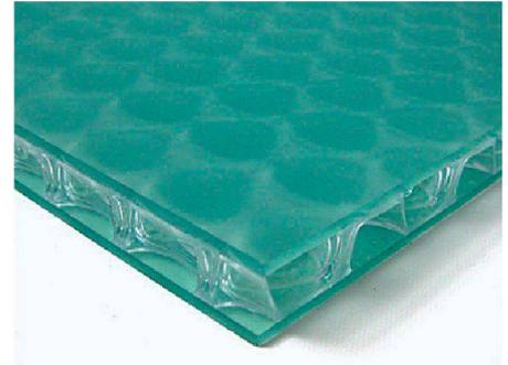
Neomat AG fertigt wetter- und lichtbeständige sowie schlagfeste Kunststoffe. Sie zeichnen sich durch eine vielfältige Optik und breite Einsatzmöglichkeiten aus. Mittels einer speziellen Klebetechnologie wird bei «Clear-Pep» ein bienenwabenähnlicher Kern mit transparenten, farbigen oder satinierten Deckschichten zu einem Panel verbunden. Die Elemente sind in den Grössen 2.55x1.05 m und 3.02x1.22 m erhältlich.
