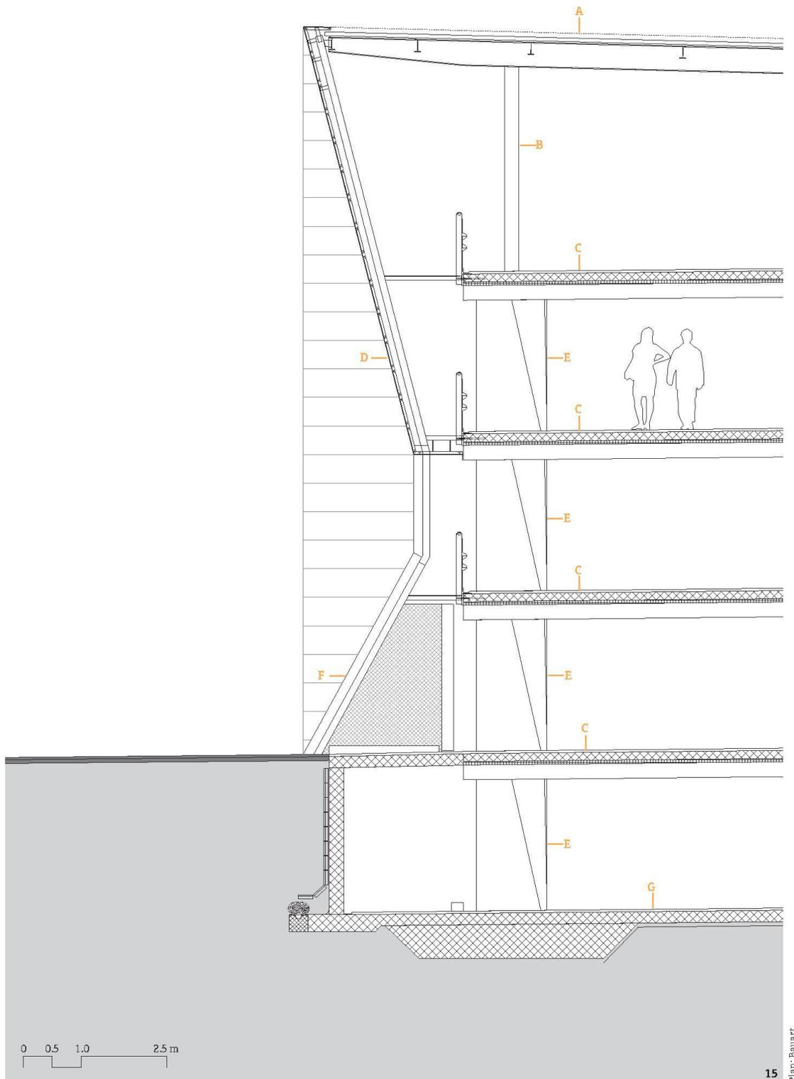
**14** Die Parkhausfassade auf der Nordseite ist im Sockelbereich mit robusten, schwarz durchgefärbten Betonfertigteilen ausgeführt. Die zur Belichtung und Belüftung notwendigen Öffnungen sind nach einem zufällig wirkenden Pixelmuster verteilt
