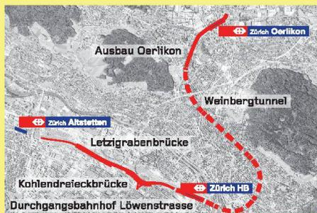
01 Der Verlauf der Durchmesserlinie. Die S-Form ergibt sich aus der Fahrgeometrie, da der Tunnel mit 120 km/h befahren werden soll (Plan: SBB)
