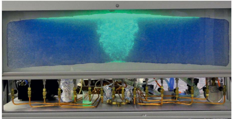
**01** Auf Knopfdruck wird im Glaskasten visualisiert, wie flüssiges CO<sub>2</sub> in eine salzwasserführende Gesteinsschicht injiziert wird und sich bis zur Deckschicht ausbreitet (Foto: SPL, ETHZ)
