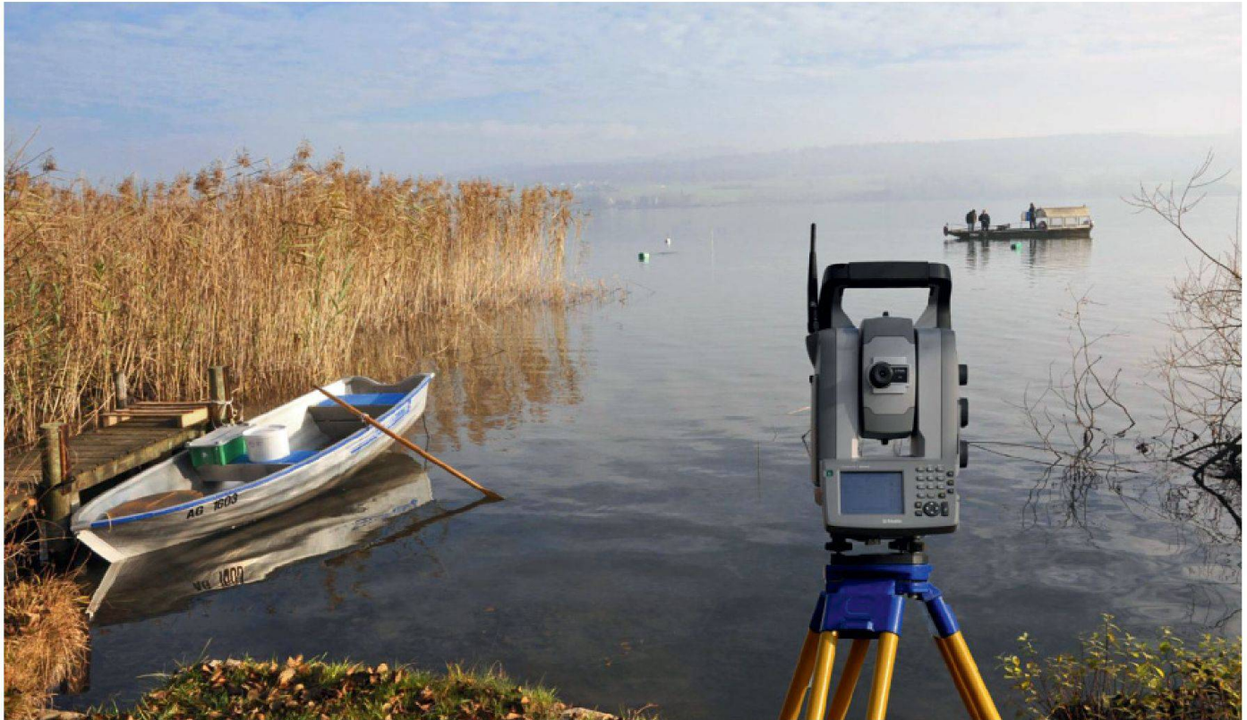
01 Blick auf die Fundstelle Beinwil-Aegelmoos im Hallwilersee. Im Vordergrund: Theodolit zur Setzungsmessung der Lastplatte (Foto: Jochem Seifert, HSR Hochschule Rapperswil)
