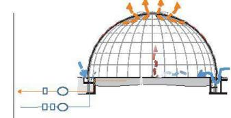
Kühlen mit Klappen (Konvektion), ohne Lüftung
