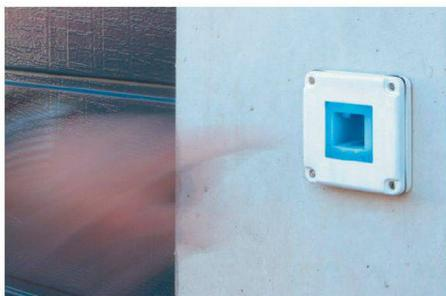
Das biometrische Zutrittssystem «overto» von Feller schaut uns künftig noch genauer auf die Finger: Dank einem neuen Finger-scanner mit kapazitivem Zeilensensor werden Erkennungs- und Auswertungsleistung nochmals deutlich optimiert. Neu werden nicht mehr nur Informationen auf der Haut, sondern auch von tiefer liegenden Hautschichten erfasst. Das macht den Scanner schneller, präziser und unempfindlicher gegenüber Umwelteinflüssen.
