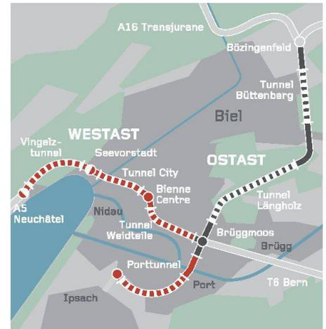
**01** Der Westast der N5 verbindet die Verzweigung Brüggmoos mit der bestehenden Autostrasse am linken Bielerseeufer. Zum Westast gehört auch der Zubringer rechtes Seeufer mit dem Porttunnel. Der Ostast ist seit 2007 im Bau und wird 2017 in Betrieb genommen. (Karte: Tiefbauamt des Kantons Bern)
