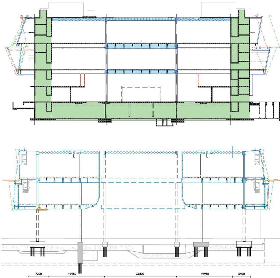
Querschnitt durch das Tragwerk im Bereich der Ausstellungshallen: Auf dem UG und zwischen den beiden Betonkernen (grün) ist das Haupttragwerk angeordnet. An den Aussenflächen dieses quaderförmigen Tragwerks aus linearen Tragelementen schliessen jeweils sekundäre Tragkonstruktionen an. Sie halten die Fassade und geben dem Gebäude erst seine typische Form.
