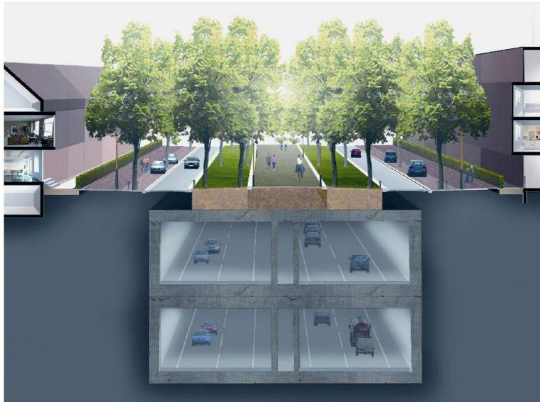
Die Konstruktionsdicke von Sohle und Aussenwänden beträgt ca. 1 m. Die Zwischendecke und die obere Decke sind jeweils 0.8 m dick, die Zwischenwände 0.5 m.
