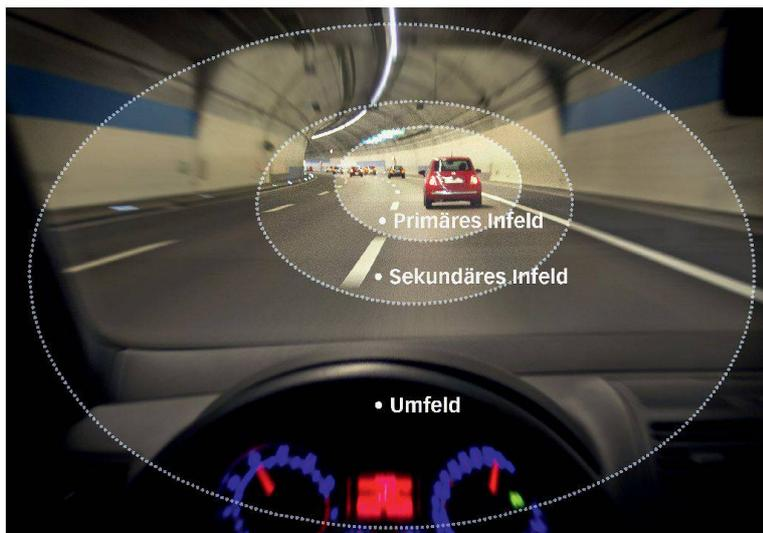
Darstellung des Gesichtsfelds. **Umfeld:** Decke, Wände, peripherer Gesichtsfeldanteil, Lichtsystem, Hinweisschilder; **sekundäres Infeld:** unmittelbare Umgebung des aktuellen Blickpunkts, Fahrbahn; **primäres Infeld:** aktuell fixierter Punkt: vorausfahrendes Fahrzeug, Armatur, Fernpunkt, evtl. Hindernis auf der Fahrbahn.
