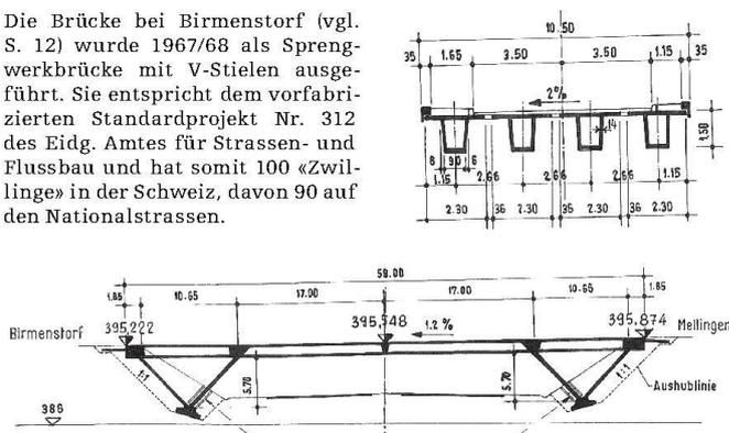
Die Fahrbahn besteht aus Hohlkastenträgern (Querschnitt, oben), die aus vorgespannten Kastenenelementen (Ansicht, darunter) zusammengesetzt sind. Nach dem Vergiessen der Fugen werden sie zusätzlich mit zwei Durchschubkabeln pro Steg vorgespannt.
