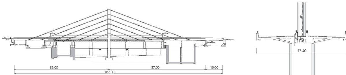
1. Preis: «Säguubrügg»: 15-feldrige, aufgehängte Betonfahrbahn ( $l/h = 9$ ). Schrägseile in einer Ebene mit zentralem Pylon.
