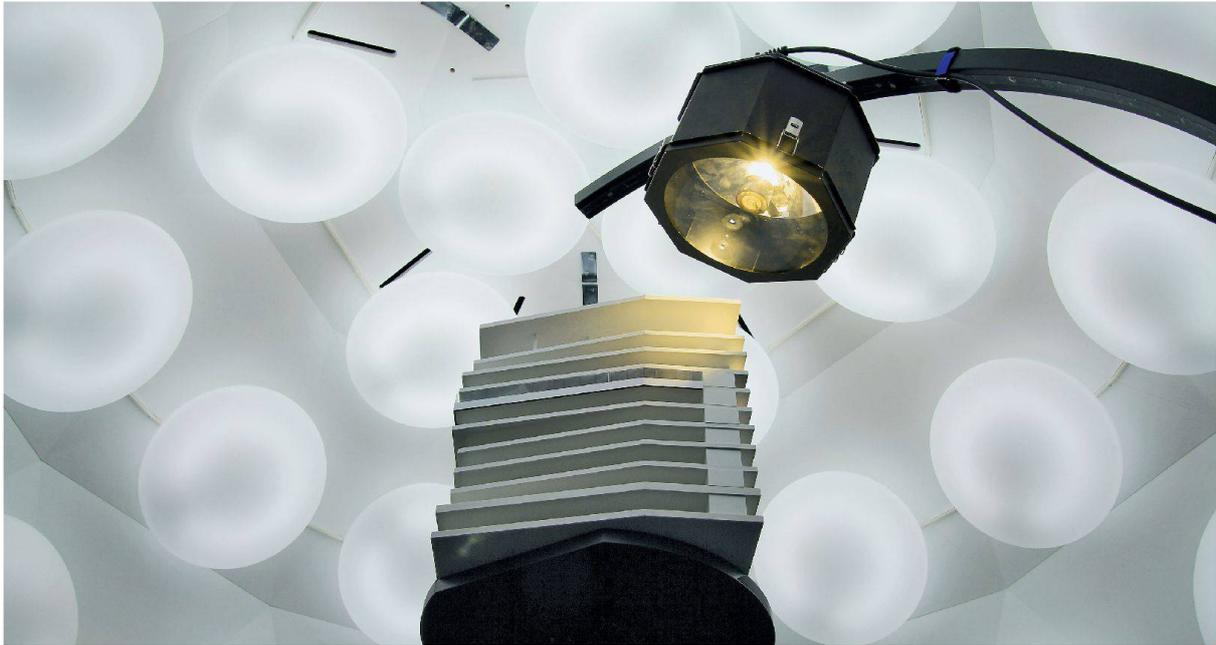
Das Modell unter dem Tageslichtdom. Der Aufbaustrahler simuliert den direkten Sonneneinfall.
