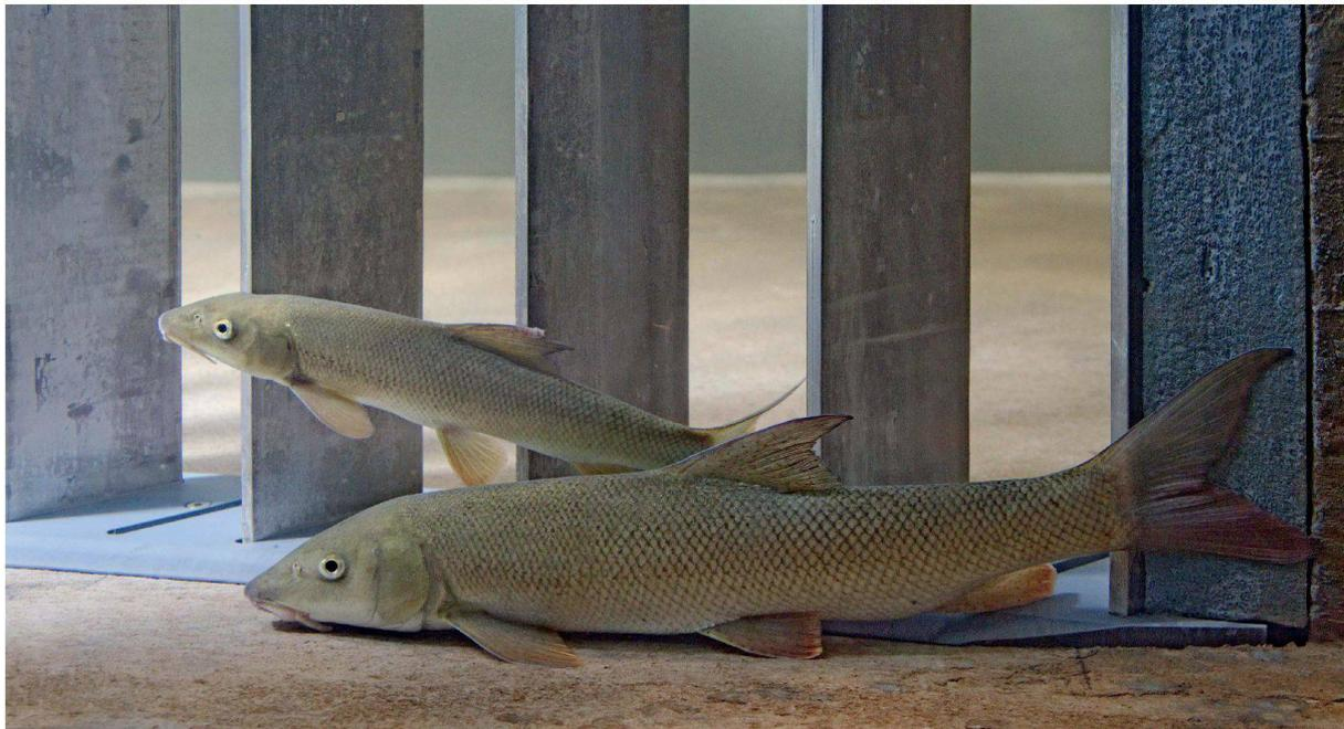
Ein Barbenpaar in der Versuchsanlage vor dem Leitreechen: **Die Fische lassen sich rückwärts die Strömung hinuntertreiben** und tasten mit der Schwanzflosse an den Stäben. Die Hauptströmung passiert den Rechen – das wäre der Weg durch die Turbine. Gleiten sie aber an den Stäben vorbei, finden sie den Einstieg in den Bypass.
