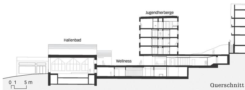
konnten die Planer eine Sondergenehmigung erwirken. Ausschlaggebend dafür war unter anderem die Wahl von robusten Holzbauteilen, in diesem Fall 160–200 mm starken gipsfaserverkleidete Brettsperrholzwände für die brandabschnittsbildenden Innenwände sowie massive Holz-Beton-Verbunddecken.
