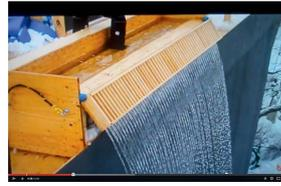
③ Dan Euser testete die Wasserfälle an einem Modell in Originalhöhe – im Hinterhof seines Zuhauses. <http://bit.ly/1z1WrcF>
