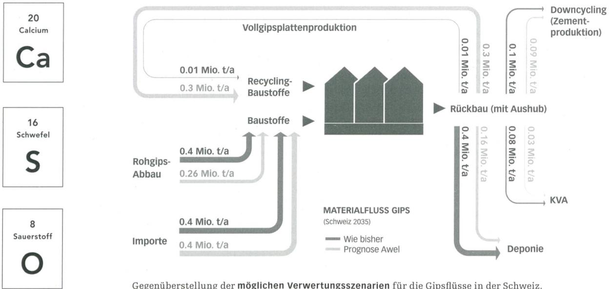
wicklung abgeschätzt: Welche Gipsmengen wurden in der Vergangenheit respektive werden heute und in Zukunft produziert, importiert und deponiert? Zudem wurde untersucht, in welchen Bauprodukten Gips eingesetzt wird und wie gross die Massenflüsse sind. Darauf basierend wurde das Verwertungspotenzial für Gips abgeschätzt.
