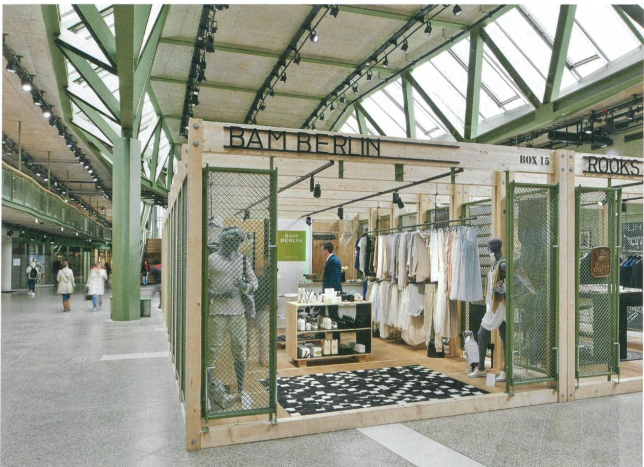
Concept-Mall «Bikini Berlin»: **Material- und Farbgebung** mit gewachstem Stahl, Stahlbeton und dem Bodenbelag aus geschliffenen Gehwegplatten **orientieren sich am Berliner Aussenraum**. Brandschutztechnisch funktioniert die Mall wie ein Kaufhaus: mit einer flächendeckenden Sprinkleranlage und zusätzlichen Brandmeldern auf den oben offenen Boxen. Die Gastronomie ist an den Enden des Baus platziert – der kurzen Fluchtwege wegen.
