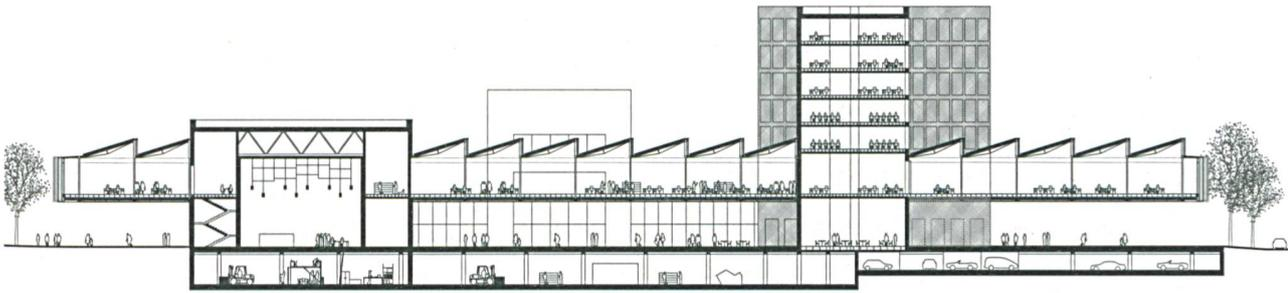
**Auf 7 m über Grund verbindet die Plattform die vier Kuben:** Das siegreiche belgische Büro nimmt mit der angehobenen Ebene ein Element des Masterplans von 1970 für die EPFL von Zweifel und Strickler auf (vgl. TEC21 49–50/2013). Schnitt im Mst. 1:1000.
