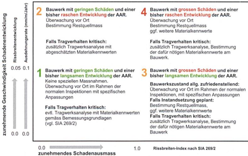
Schadenausmass und -entwicklung der AAR können bereits bei der Zustandserfassung definiert werden und dienen als Basis für die Wahl geeigneter Massnahmen.
