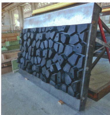
Links: Die Negativform des «organischen» Musters wurde mit einer PVC-Matrix realisiert. Rechts: «organischer» Steg und Fuge zwischen zwei Fertigteilen.
