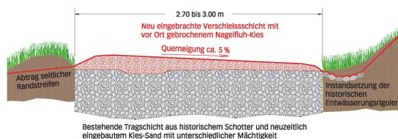
**Normalprofil Panoramaweg:** Die Instandsetzungsarbeiten am Trassee beeinträchtigten die bestehende Tragschicht nicht. Diese ist eine von der ehemaligen Bahnnutzung gut verdichtete Grundlage, die es ermöglichte, nur die oberste Verschleisschicht zu bearbeiten.
