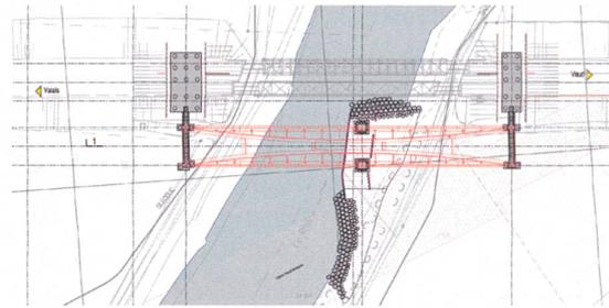
Vorschub der neuen Brücke über die Rhone auf die Vorschublager; **Betonierarbeiten des Trogs, Einbau des Schotterbetts.**
