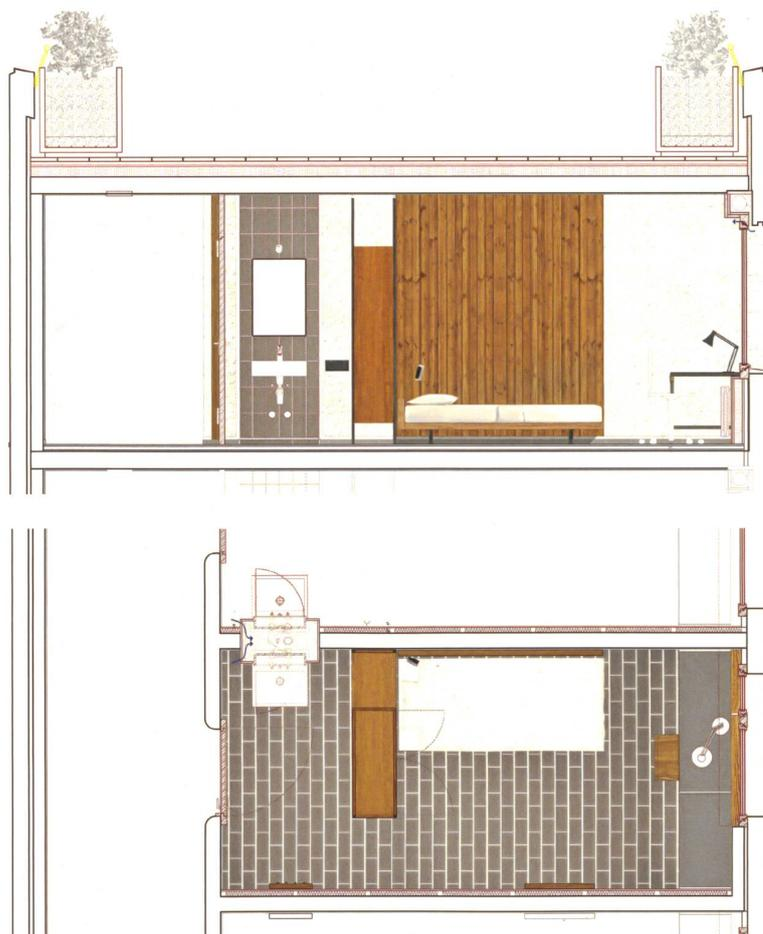
**Siegerprojekt «Weniger ist mehr»:** Detailschnitt (oben) und Grundriss eines Einzelzimmers (ohne Mst.) mit den geplanten Eingriffen: Innendämmung an den Brüstungen, Schallschutz mittels einseitiger Vorsatzschale zwischen den Zimmern und neue Steigzonen im Bereich der Waschbecken.
