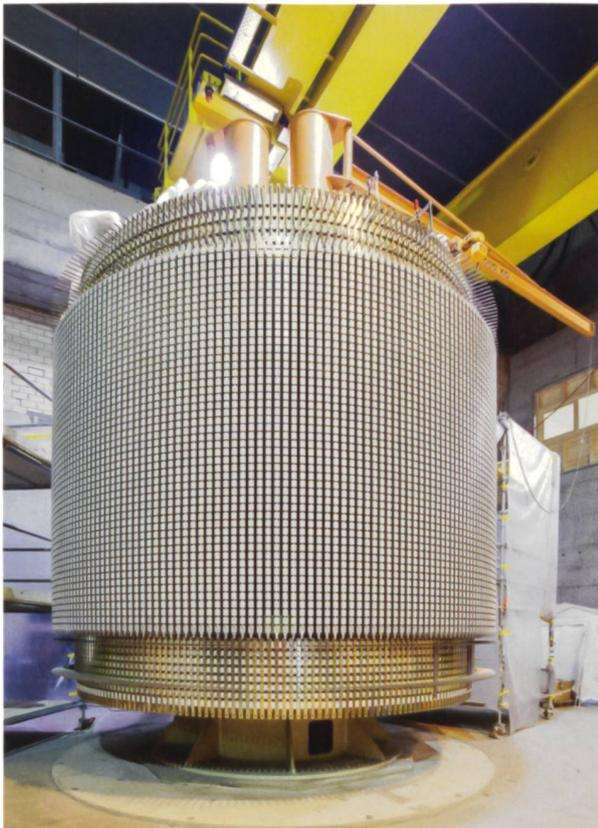
Rotor eines der vier Motorgeneratoren.
