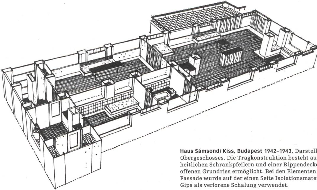
**Haus Sámsondi Kiss, Budapest 1942–1943**, Darstellung des Obergeschosses. Die Tragkonstruktion besteht aus einheitlichen Schrankpfeilern und einer Rippendecke, was einen offenen Grundriss ermöglicht. Bei den Elementen an der Fassade wurde auf der einen Seite Isolationsmaterial statt Gips als verlorene Schalung verwendet.
