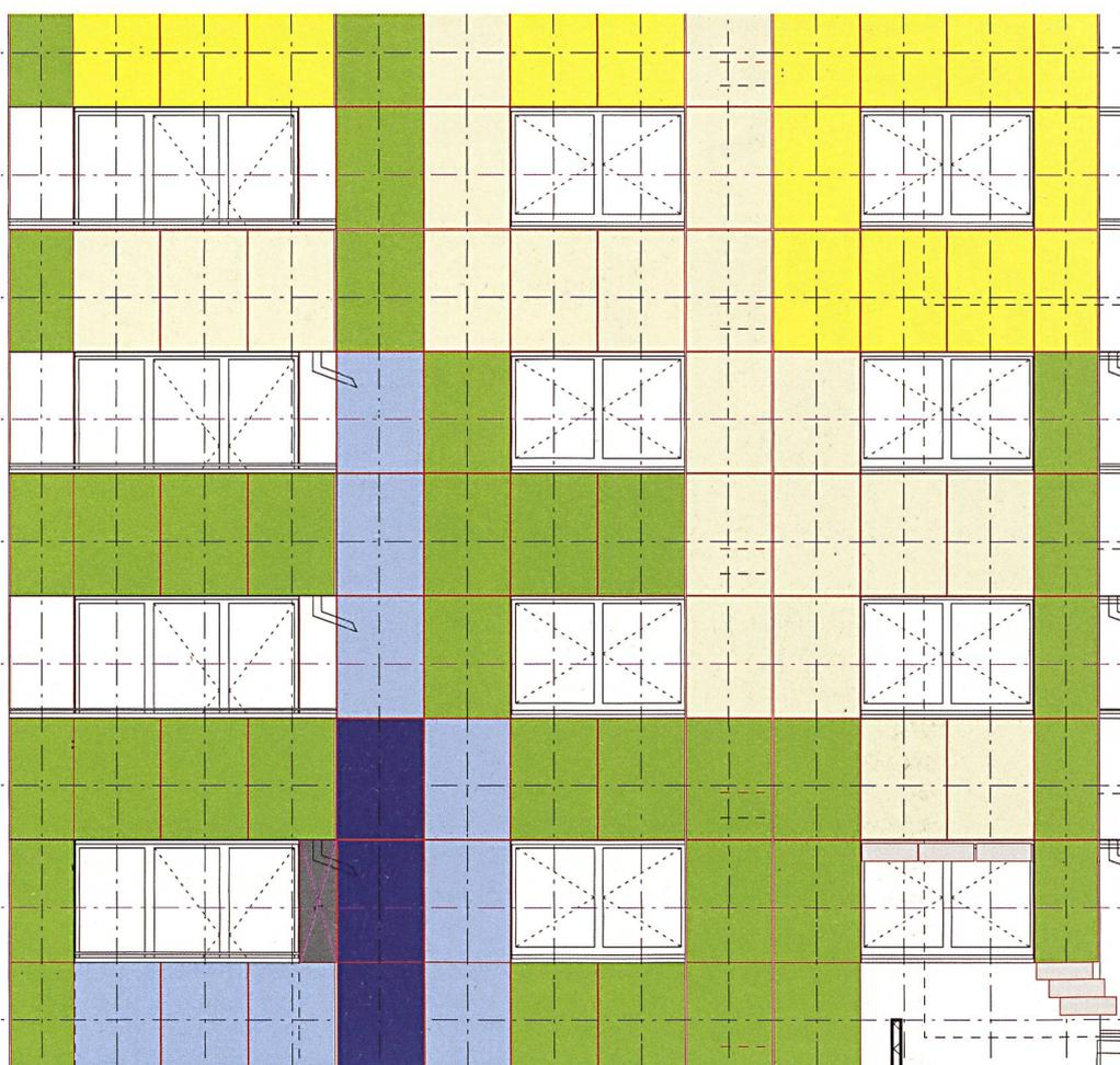
Schematische Ansicht der Südfassade: Die Module sind entsprechend der an einem Tag produzierten Stromerträge eingefärbt. Der untere Fassadenbereich liegt teilweise im Schatten des Nachbargebäudes.
