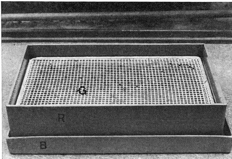
Abb. 1. — Aus PVC (hart) gefertigte Aussaatkiste. R = Rahmen, B = Bodenteil, G = Auf Zwischenrand ruhendes Gitter
