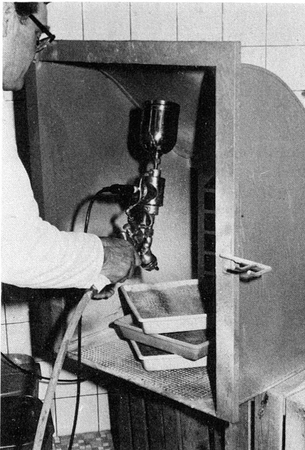
Abb. 2: Paraffinierung des in die Schalen eingefüllten Nährbodens (Photo A. Staub).
