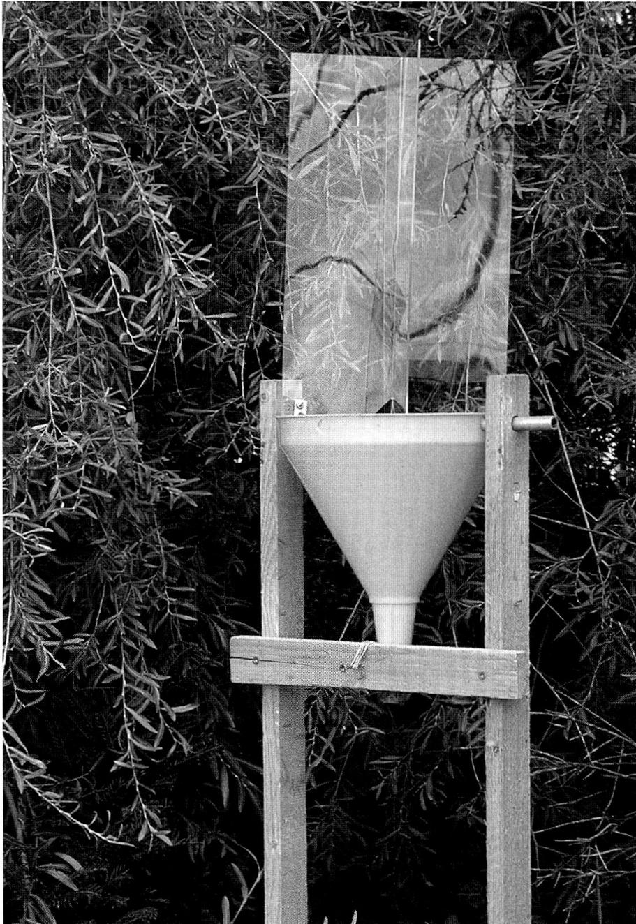
Abb. 1: Kombinationsfalle: Kombination aus Fensterfalle und Gelbschale nach Duelli *et al.* (1999), mit der flugfähige Insekten in der Agrarlandschaft des Reuss-Tals im Kanton Aargau, Schweiz innerhalb des EU-Projektes «Greenveins» gesammelt wurden.
