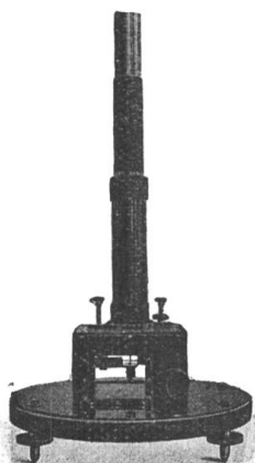
Abbildung 2. Radium-Perpetuum mobile; Ansicht ohne oberen Teil.
