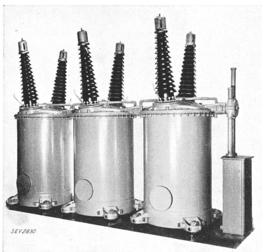
Fig. 22a. Gruppe von drei einpoligen 150-kV-Oelschaltern, 400 A, 1500 MVA, mit 6facher Unterbrechung (geschlossen).
