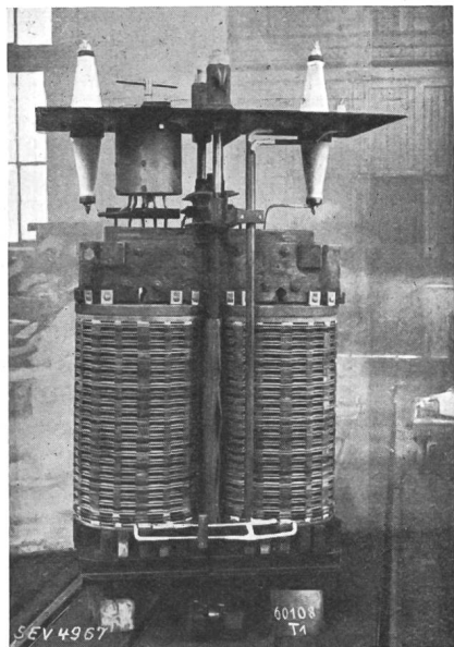
Fig. 15. Ansicht des aktiven Teiles einer Löschspule.
