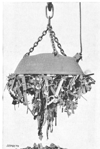
Fig. 5. Lasthebemagnet. Die Windungsisolierung besteht aus Aluminium-Oxyd.
